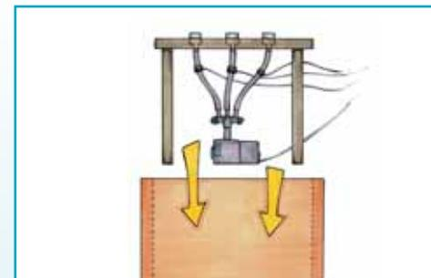
Расположите весь набор в садовой вазе. Положите пенный коврик (для звукоизоляции) с соответствующими отверстиями на деревянный каркас. Отрегулируйте крышки из нержавеющей стали для соответствующей высоты фонтана.
