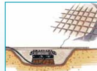
Продолжаем с покрытием. Для предотвращения скольжения, покрытие должно быть достаточно большим, чтобы выступать за края углубления. Установите покрытие над углублением и водным объектом. Пожалуйста, убедитесь в том, что отверстия для фонтанных насадок расположены в нужных местах.
