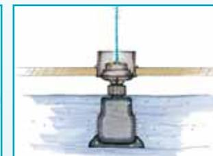
*Вариант 2: насосы устанавливаются ниже несущей пластины. В этом случае держатель насадки привинчивается сверху.*
