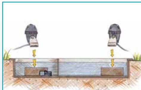
Разместите «JumpingJet Rainbow Star Set» на подставке и закрепите. Выберите погружаемую глубину «JumpingJet Rainbow Star Set» так, чтобы поверхность воды была ниже насадок. Установите насос также в воде и подключите шлангом к «JumpingJet Rainbow Star Set».
