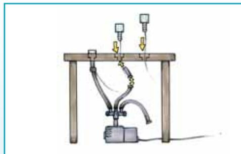
Затем поместите насос с 3-сторонним распределителем под рамкой и соедините шлангами распределитель и «LunaLed 9 s». Для выхода кабеля питания, распределите шланги так, чтобы они соответствовали разделам на шланговом соединителе. Пропустите кабель через небольшое отверстие в шланговом разъеме.
