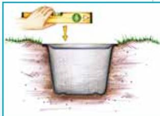
Поместить резервуар WR 60 с соответствующим покрытием WR-T 60 в землю, при этом строго соблюдая горизонтальную установку.
