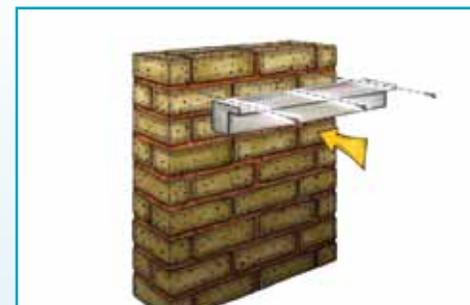
Используя отверстия на задней панели «Waterfall 60» привинтите его на стене – строго следя за тем, чтобы водопад был закреплен горизонтально. Проверьте горизонтальное выравнивание строительным уровнем. В этом случае шланг может быть прикреплен снизу, в качестве альтернативы он может быть подключен на задней панели.
