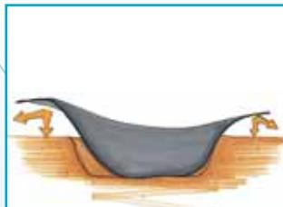
Затем углубление выстлать пленкой для прудов. Для предотвращения скольжения, покрытие должно быть достаточно большим, чтобы выступало за края углубления. Затем залить воду.
