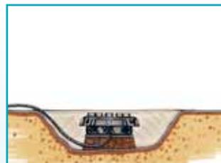
Разместить «Water Trio/Quintet» в нужном положении. В зависимости от глубины ямы может потребоваться использование подставки, такой как кирпичи. Когда «Water Trio/Quintet» установлен, насадки можно выровнять, соответственно для желаемого фонтана.
