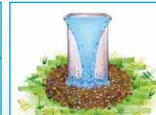
Вставьте заднюю панель, установите ее на месте с помощью прилагаемого крепления – вот и все! Украсьте крышку резервуара по желанию, галькой, например. Небольшой холмик из гальки, прямо под струей воды поможет уменьшить разбрызгивание воды.
