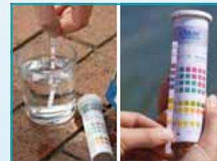
Используйте анализатор-тест воды «Quickstick» для проверки качества воды перед заполнением бочки
