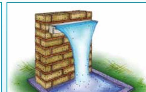
В идеале насос не должен быть непосредственно в месте удара воды для того, чтобы струя оставалась ламинарной.
