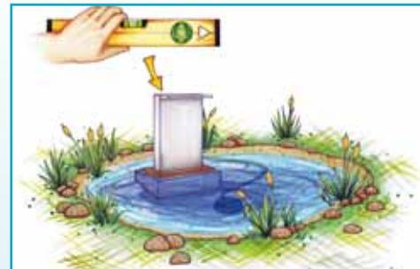
*Обеспечить строгую горизонтальную установку, использовать строительный уровень для получения идеального водного объекта.*
