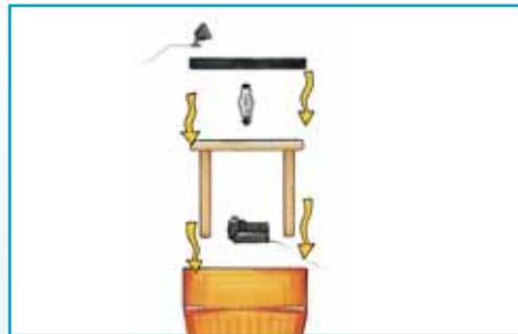
Поместите полный набор в садовой вазе. Поместите затем пенный коврик (для звукоизоляции) с отверстием для насадки на деревянной рамке!
