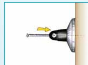
*Для размещения на стене, необходимо утопить прилагаемые крепления в стене, отсоединить подставку шестигранным ключом, вставить винты из нержавеющей стали в отверстия и привинтить устройство на стену.*
