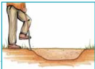
В соответствующем месте выкопать яму диаметром минимум 1 м и глубиной 40 см.
