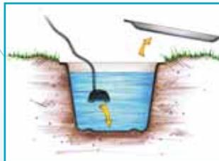
Подключите насос к прилагаемому шлангу и поместите его на дно резервуара. Затем шланг, а также силовой кабель могут легко выноситься через отверстия в крышке. Заполните резервуар водой.
