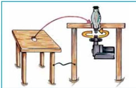
Сначала выберите рамку, которая оптимально подходит к нужной садовой вазе и обеспечивает идеальную высоту для водного объекта. Если еще нет отверстий, просверлите их в панели рамки и вложите крепления фонтана в отверстия. Убедитесь, что крепления фонтана прочно сидят и не проскакивают. Винтом привинтите насос к соответствующему креплению под насадкой.
