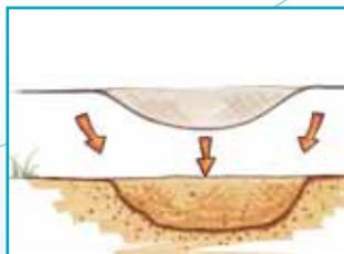
Углубление выстлать пленкой для прудов и выложить ее таким образом, чтобы она чуть выходила за края. Диаметр пленки должен быть не менее 3 м.
