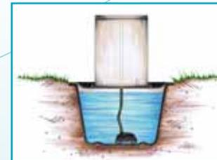
Теперь все собрано вместе: после того как все шланги и кабели пропущены через крышку, нужно ее установить и подключить шланг внутри со штуцером водопада. Для этого задняя стенка легко снимается.
