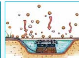
Залейте воду и украсьте поверхность вокруг фонтана. Для этого мы рекомендуем мелкую, промытую гальку. Галька должна быть больше в диаметре, чем отверстия покрытия, в противном случае камешки упадут сквозь отверстия.
